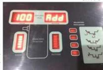
8. Примечание: Положение 12 часов для добавления грузика должно быть точным. Это серьезно влияет на правильность положения дисбаланса. После остановки шины, если отображается [CAL][End], калибровка завершена.
